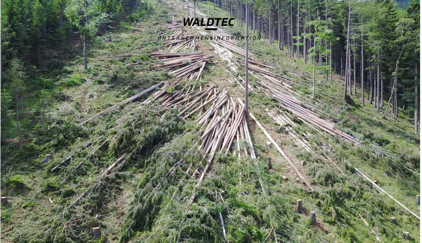
aufgebaut auf einen MAN-Lkw. Durch seine hohe Laufwagengeschwindigkeit, verbunden mit der Ziel- und Sattelautomatik sowie einer Funkfernsteuerung, war dieses Gerät für den beschriebenen Einsatz die optimale Ergänzung. Bei einer Trassenlänge von 265 m waren eine Stütze und ein Endmast erforderlich. Die Bringung wurde nur von zwei Männern (Maschinist und Anhänger) durchgeführt. Durch die Vorbündelung der großteils entasteten Bäume konnte ein höheres Fuhrvolumen erzielt werden.
