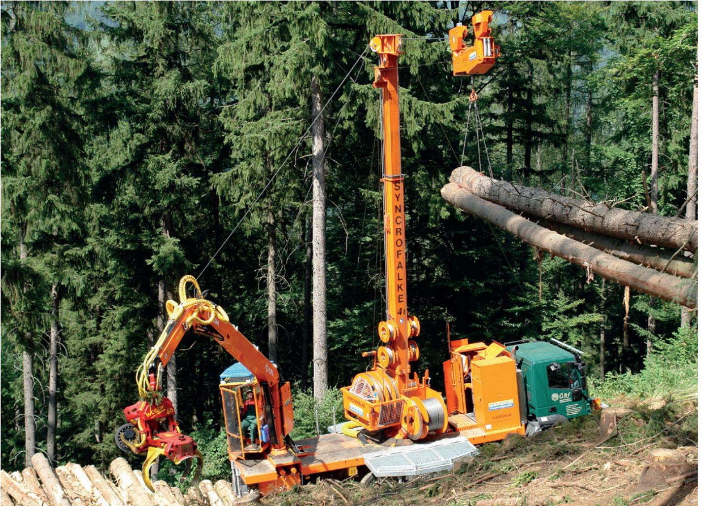
Das Forstseilgerät Syncrofalke® ist ein universell einsetzbares Kippmastseilgerät. Es ermöglicht Bringungsarbeiten bergauf, bergab und in der Ebene. Zu den besonderen Kennzeichen gehören:
