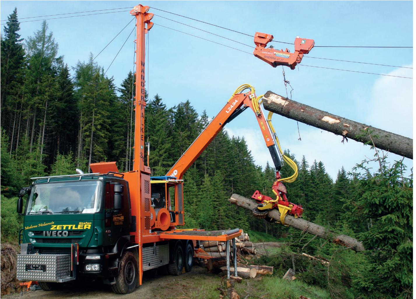
Der Wanderfalke® ist ebenfalls ein universell einsetzbares Gerät, das aufgrund der schnellen Montage, der leichten Bedienung sowie durch hohe Zugkräfte und Arbeitsgeschwindigkeiten große Bringungsleistungen ermöglicht. Es sind Arbeiten sowohl im 2- auch 3-Seil-Verfahren möglich. Die Einsatzschwerpunkte sind kleines oder mittelgroßes Holz und die Durchforstung. Weitere wichtige Merkmale:
